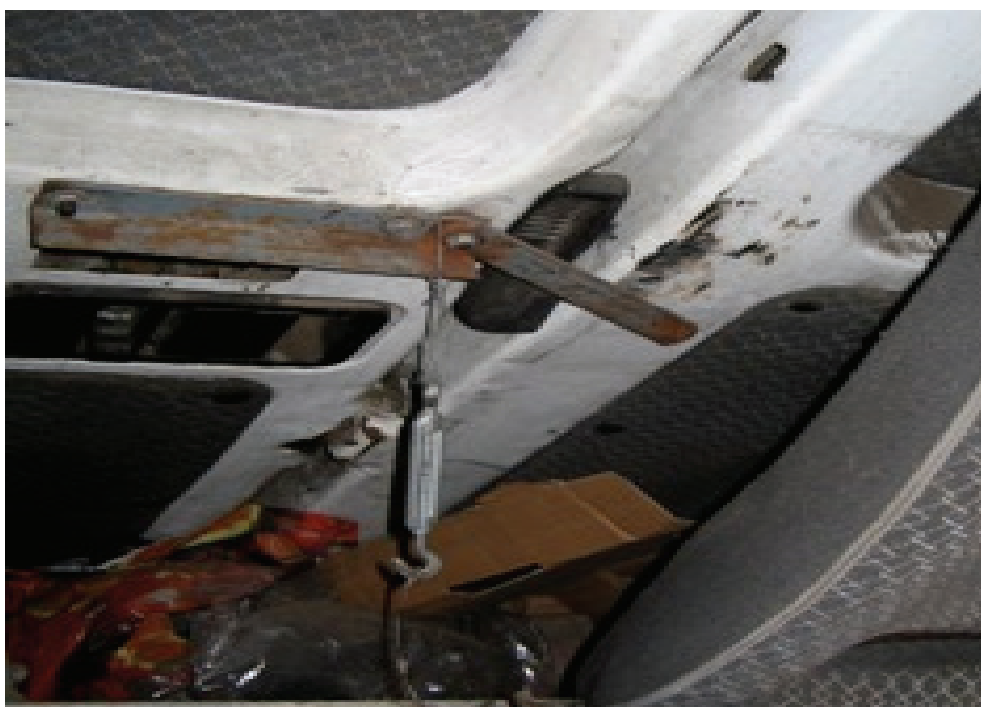
Zdjęcie nr 10 Wykonana w sposób „chałupniczy” naprawa zamknięcia drzwi tylnych mikrobusu.
