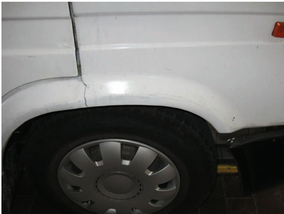
Zdjęcie nr 5 Nieprofesjonalne wykonanie napraw spawalniczych skutkujące uszkodzeniami elementów konstrukcyjnych.
