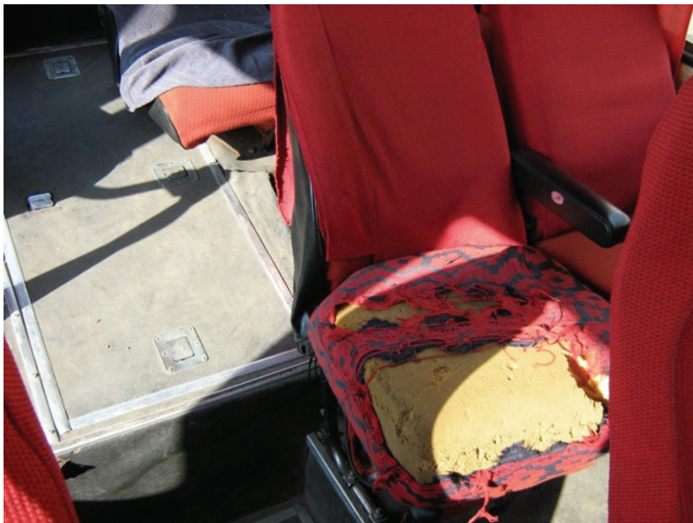
Zdjęcie nr 9 Uszkodzone siedzisko pasażera.
