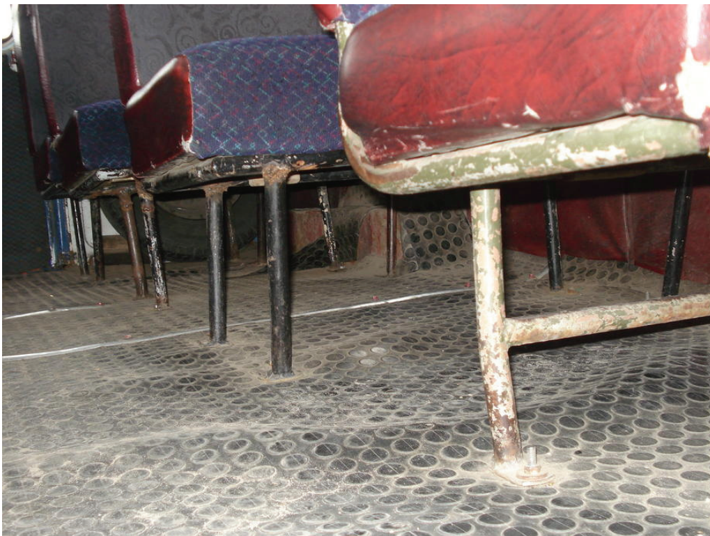
Zdjęcie nr 3 Nieprofesjonalne wykonanie napraw spawalniczych, nieprawidłowe mocowanie siedzeń, wyrwane elementy mocujące.
