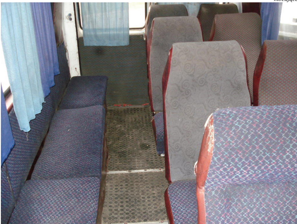
Zdjęcie nr 4 Samodzielnie zamontowane - w sposób niedozwolony, siedzenia dla pasażerów.
