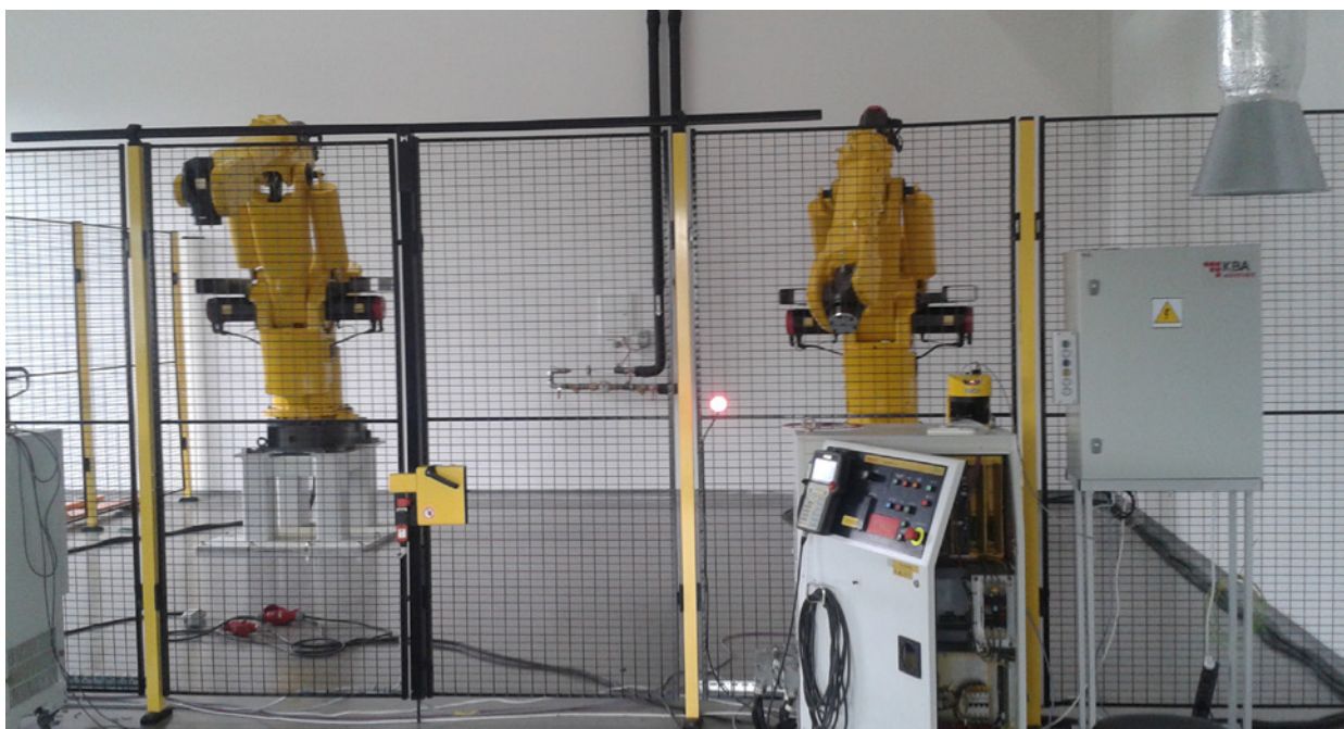
Zdjęcie nr 2 Pełnowymiarowe roboty przemysłowe Fanuc
